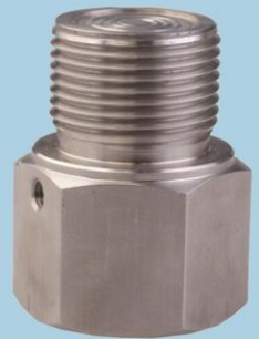
D-05 螺纹平嵌式隔膜 最低压力: -30inHg 最高压力: 900 psi
